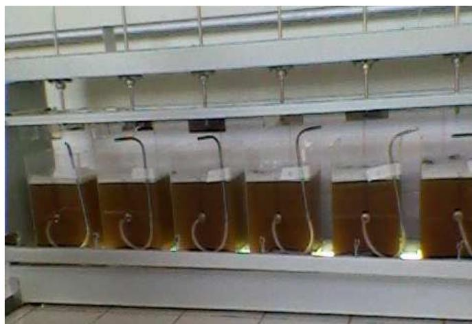
Figura 1: Equipamento de *Jar Test* de bancada com efluente bruto nos seis ensaios.
